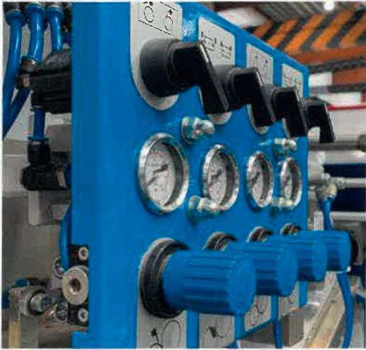
Detailansicht des Walzensteuerungsmoduls für die Direktdruckanlage „DCP“
