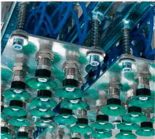
Diverse Vakuum-Sauger sorgen für ein exaktes Positionieren, bzw. Fixieren der Werkstücke bei bis zu 50 m/min. Vorschub
