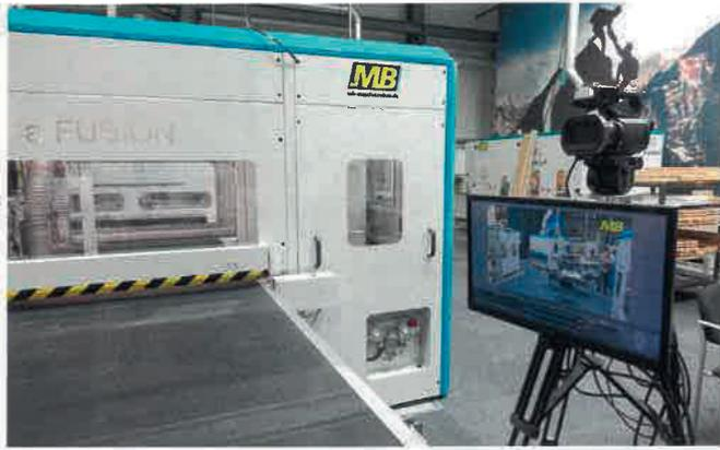
**Der modular aufgebaute Doppelendprofiler „Roba Fusion“ von MB Maschinenbau kann rationell mit wahllosen Teilegrößen beschickt werden**
