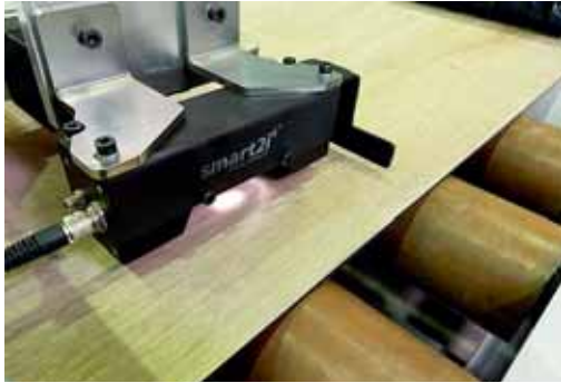
Oben: Sensor zur kontinuierlichen Erfassung des Glanzgrades einer Oberfläche. Rechts: Beispiel Glanzgradabweichung: Die intelligente Verknüpfung verschiedener Prozessdaten ermöglicht Hypothesen
