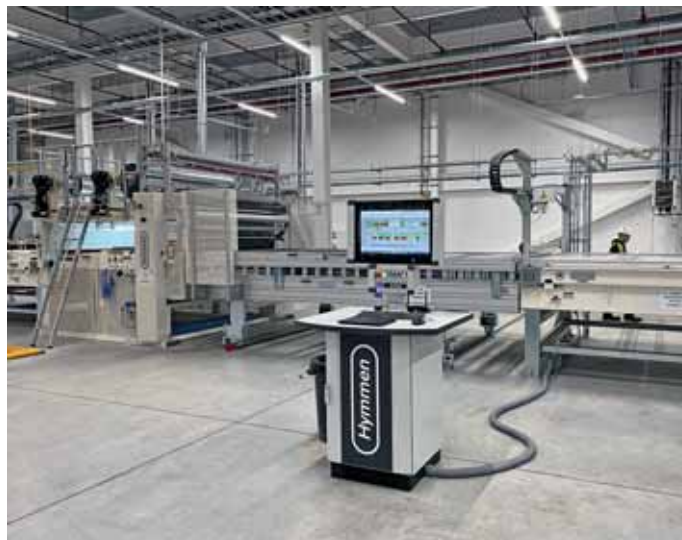
Der Kalandrier (links), das Herzstück der CCI-Linie, sowie das Bedienfeld.
