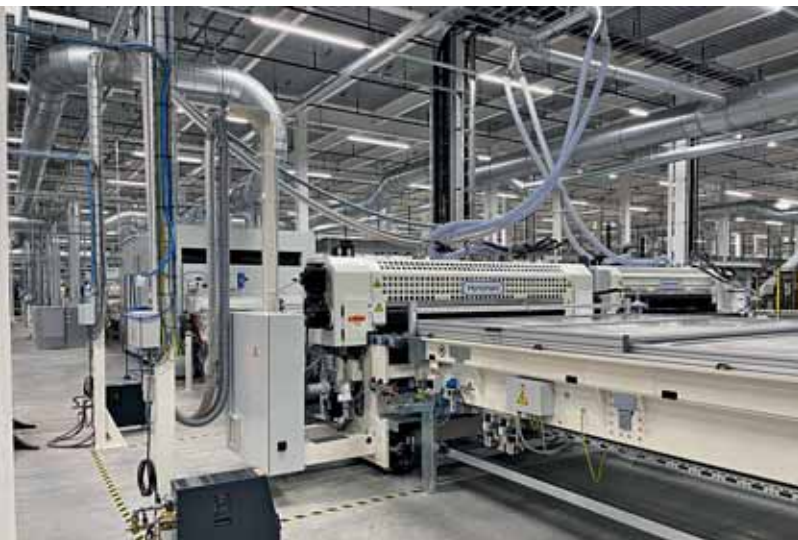
Walzenauftragsmaschinen vom Typ „UME“ an der CCI-Linie.
