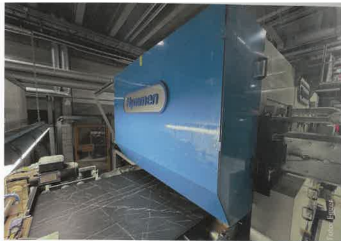
Arbeitsplatten beim Auslauf aus der TFL-Pressen.
