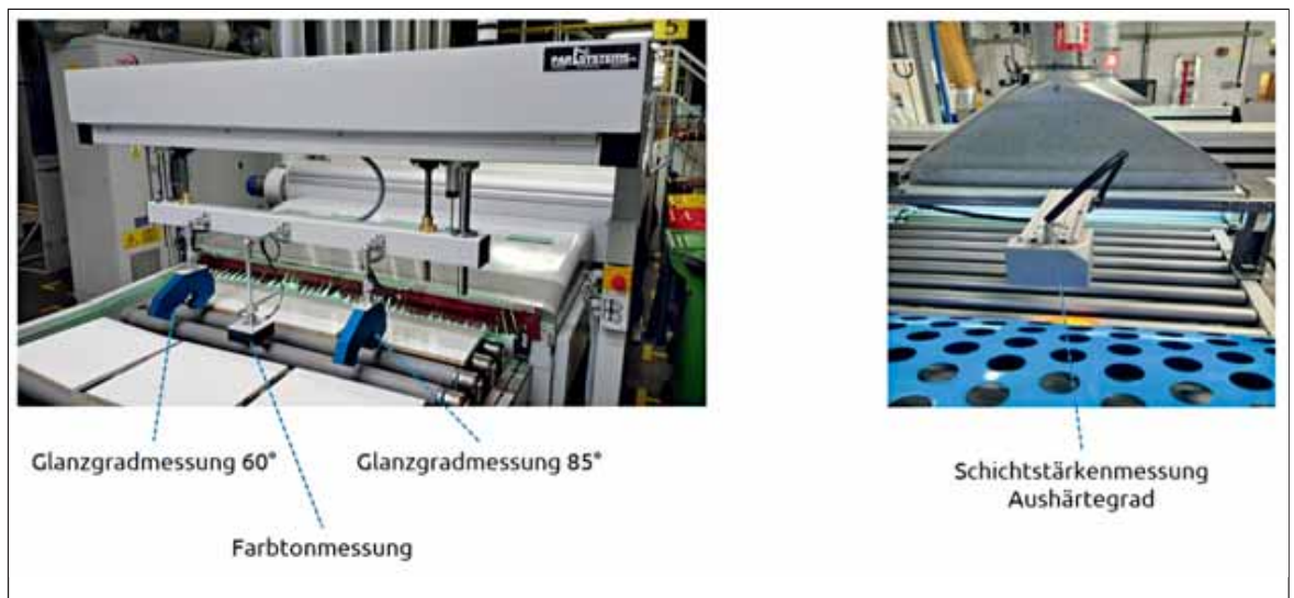
Bild 2: Integration von Sensoren in der Fertigungslinie bei Hesse Lignal.
