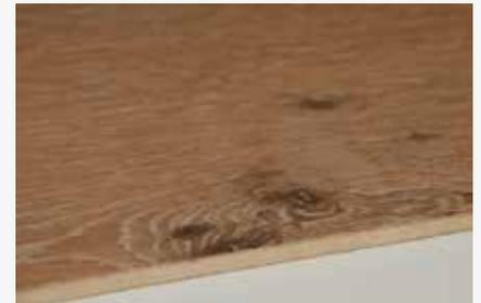
Spanplatte und MDF-Platte mit Strukturfolie kaschiert
