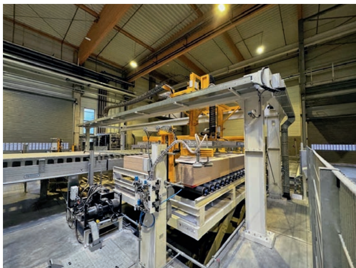
Beschickung der „TFL“-Anlage bei Egger in Biskupiec. Feeding the „TFL“ double belt press at Egger in Biskupiec.
