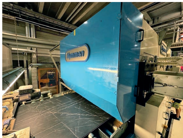
Arbeitsplatten beim Auslauf aus der TFL-Pressen. Worktops coming off the TFL press.
