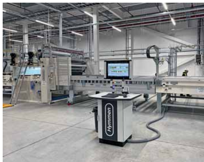
Der Kalandertank (links), das Herzstück der CCI-Linie, sowie das Bedienfeld.
