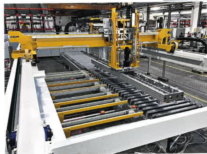
Abb. 6: Rollentransportbahn, Portal und Paternoster
