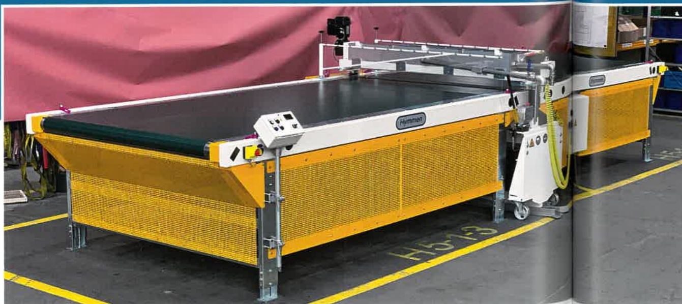
Abb. 2b: Flüssigbeschichtungsmaschine („MTC“)
