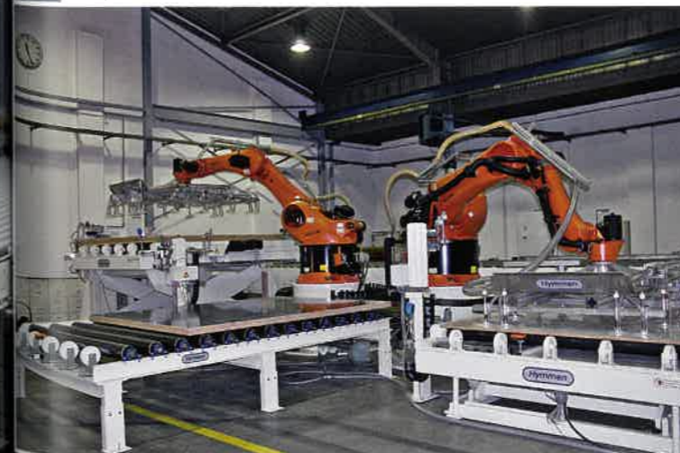
Abb. 7: Plattenwender von Hymmen vor der Auslieferung
