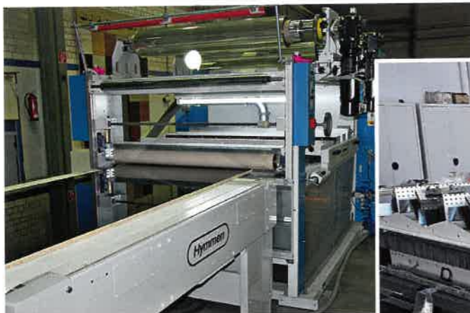
Abb.3: Calander Coating Inert („CCI“-Anlage)
