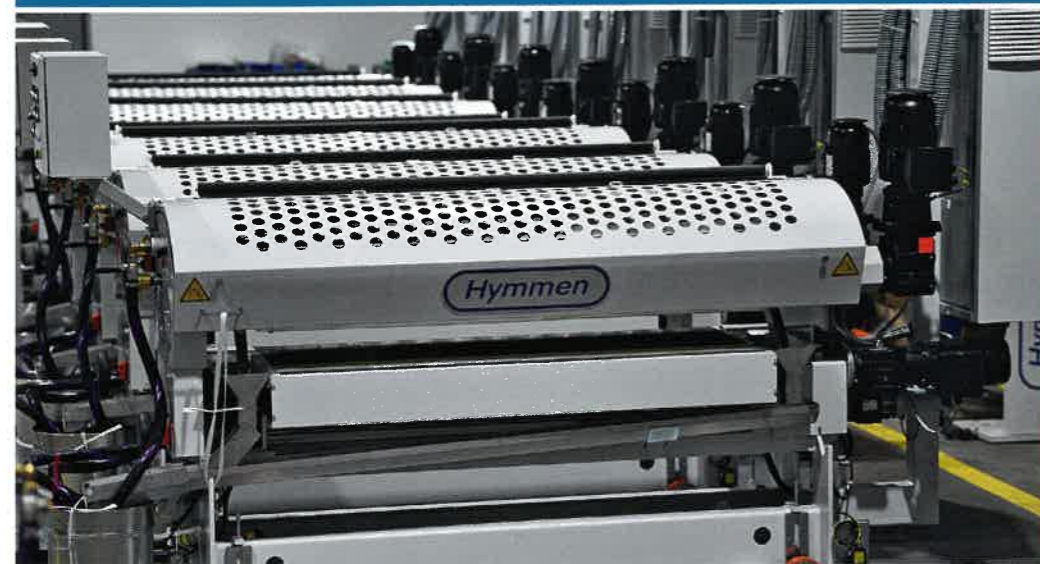
Abb. 2a: Flüssigbeschichtungsmaschinen („ULX“)
