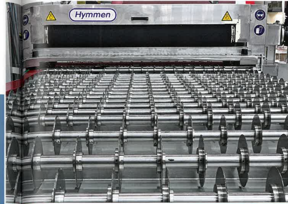
Abb. 2d: Leimauftragsmaschine („UMA“) mit Edelstahlonderausstattung
