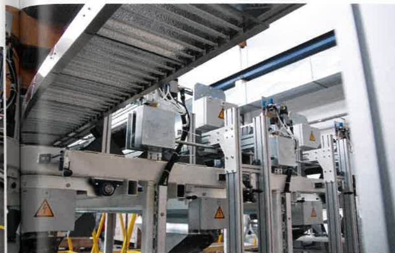
Abb. 5: Scheibentransport mit Infrarot-Trockner
