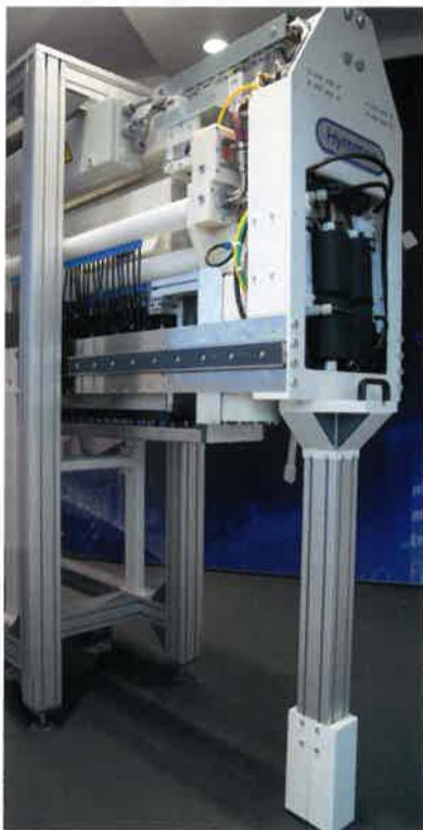
Das Kernstück der Anlage, den Druckbalken, zeigte Hymmen auf der Ligna.
