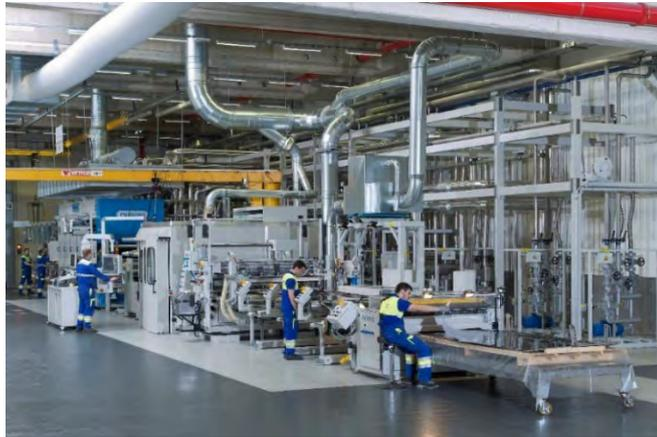
**Abb. 3: HPL-Doppelbandpresse für Hochglanzlaminat bei Egger (Foto Quelle: Egger)**
