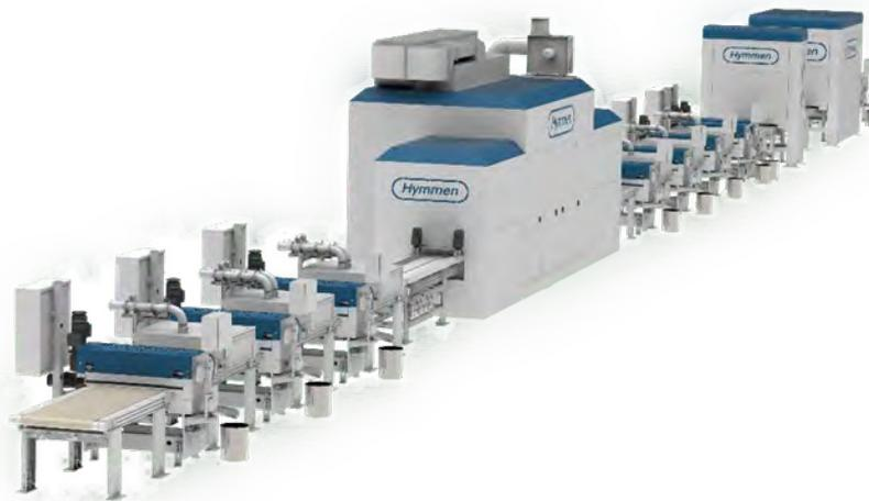
**Abb. 1: Eine komplette Linie für den digitalen Dekor- und Strukturdruck**
