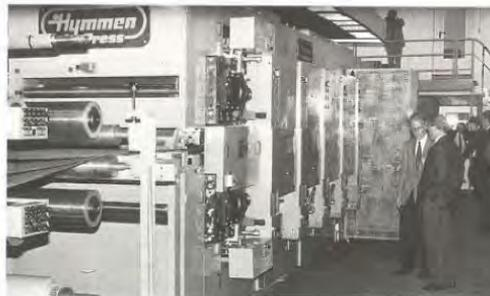
werden ideale Temperatur-Kurven bei Wahrung des erprobten, isobaren Drucksystems erreicht. Eine Bandschnellwechsellvorrichtung erlaubt zudem einen schnellen Wechsel von Prägebändern.
