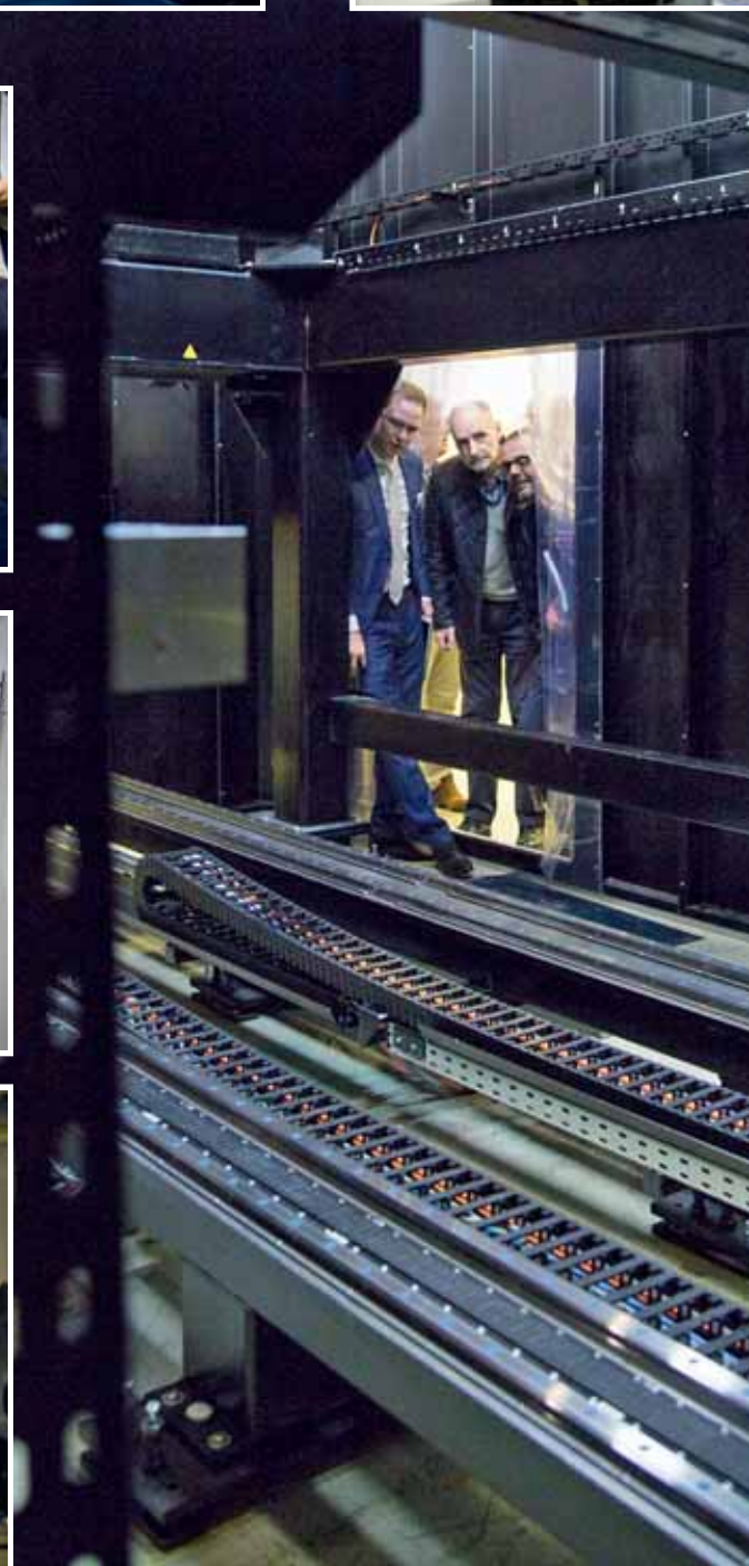
Die neueste Generation der „Jupiter“-Digitaldruckanlagen verfügt über eine neue Beschickung mit dem „Tandem Transport Linear“-System (links, Mitte) und über Druckköpfe mit Doppelbestückung der Serie „Xaar X 2001“. Auch Einblicke in die Tiefen der Technik waren bei der Hausmesse möglich
