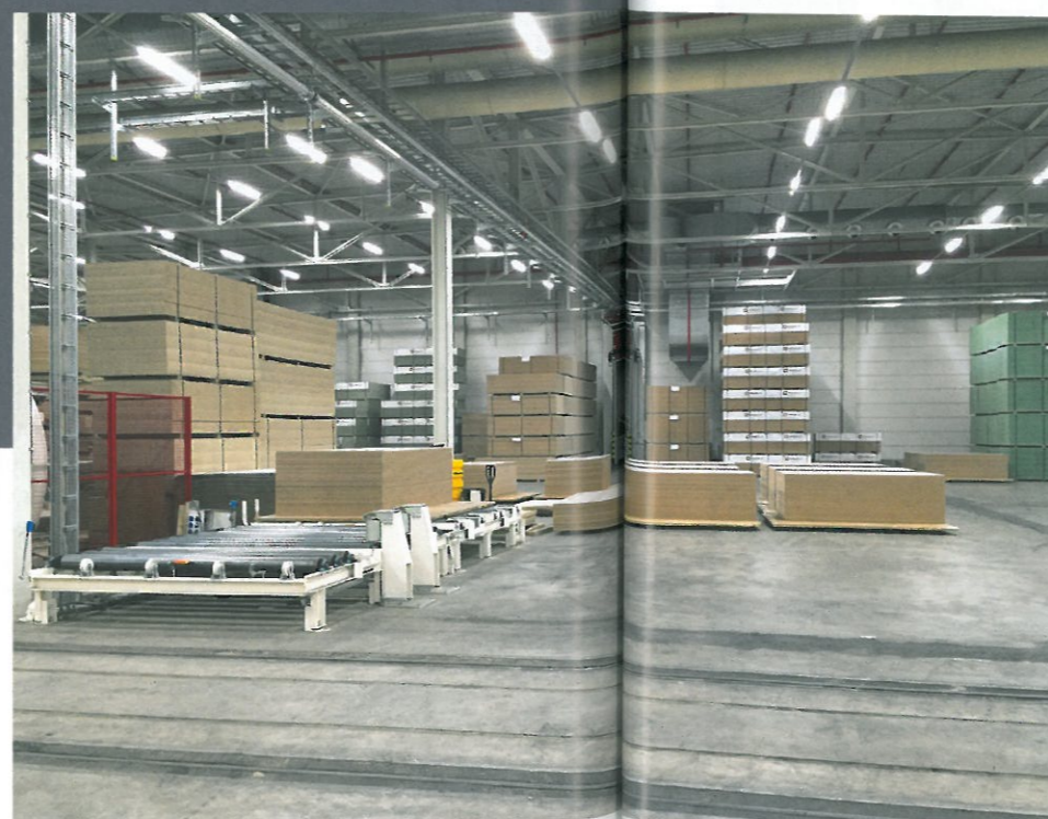
Fertige digital bedruckte Laminatboden-Vollformatplatten (1 530 mm breit) bei Balterio in Vielsam/Belgien (Fotos: Hymmen)
