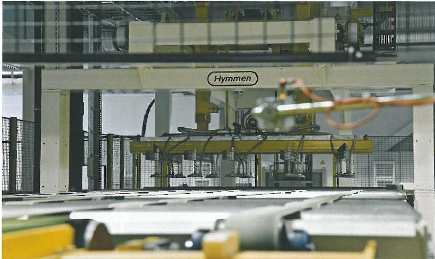
Detail bei der Beschickung: Rohplatten-übersetzer
