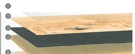
Der Produktaufbau von Woodura: Öl oder Lack (1), Holzlayer (2), holzbasierte Pulverschicht (3), feuchteresistente HDF (4), Gegenzuglayer (5) (Bild: Välinge)
