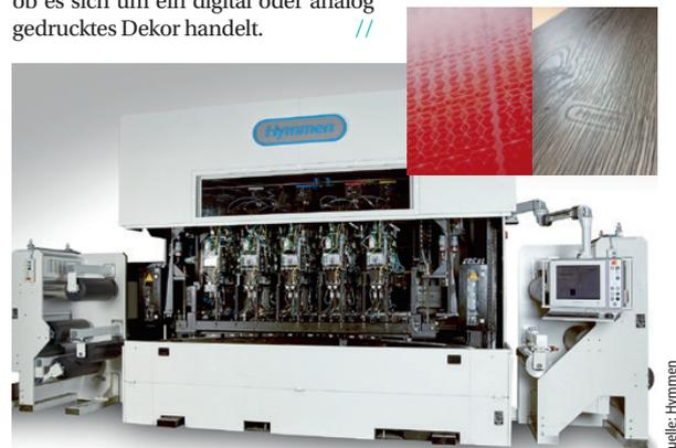
Die Hymmen-Jupiter Digital Printing Lines für Digitaldruck auf Kantenbändern – mit Digital Lacquer Embossing lassen sich verschiedene strukturierte Oberflächen erzeugen (kl. Bilder)
