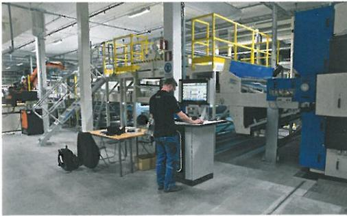
Nach der Furnierlegung geht der Weg der Platten durch die Papierabwickelstation (links Blick von oben in Produktionsrichtung)
