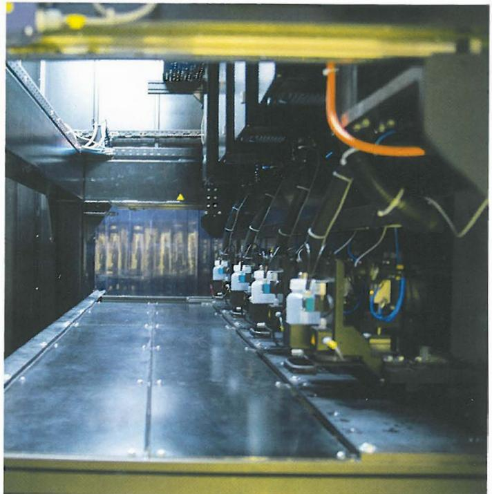
wurde". Hier kam das jüngst patentierte „Digital Lacquer Embossing“ zum Einsatz, das es ermöglicht, dem digital aufgetragenen Dekor auch noch eine digital eingedruckte Oberflächenstruktur hinzuzufügen.
