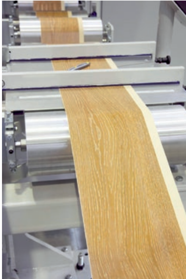
Abb. 1 Digitaler Single-Pass-Dekor-druck auf Papier (Fotos: Hymmen)
